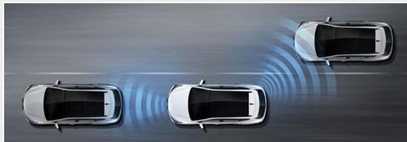
Surveillance des angles morts (BSD) et Régulateur avancé de vitesse intelligent (ASCC)
