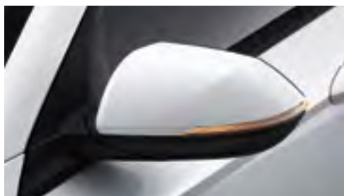
Rétroviseur extérieur (Chauffant / Rabattable / Clignotant LED intégré)
