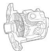
**Différentiel autobloquant** - Lorsque vous roulez sur des surfaces de route inégales, vous pouvez soudainement perdre l'adhérence et le contrôle du véhicule. Le différentiel autobloquant garantit une traction maximale. Il est automatiquement activé à des vitesses supérieures à 30 km/h et est plus efficace qu'un différentiel à glissement limité.
