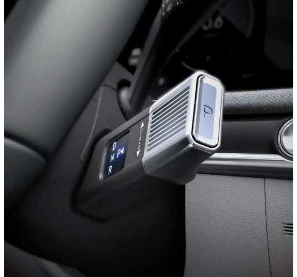
Levier de vitesse électronique (Shift by Wire) monté sur colonne
